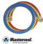
Mangueras de barreras de nylon para aplicaciones de alta presión. Presión de trabajo 800 PSI, revientan a 4000 PSI.
