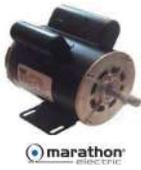
Motores de diseño de alta eficiencia con capacitor de arranque/capacitor de trabajo. Aislamiento clase F. Para uso continuo. Rotación reversible (CW/CCW). Temperatura ambiente 40 °C. Armazón 48Y con flecha de 5/8 IN de diámetro x 1.88 IN de largo, 3-1/2 IN altura de flecha y base de montaje armazón 56.
