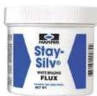
Un fundente multiuso de baja temperatura, para la utilización en la soldadura fuerte de plata. Se puede utilizar con la mayoría de los metales ferrosos y non-ferrosos, no se recomienda sobre aluminio, magnesio, y titanio. La gama de temperaturas activas es 1050 °F / 566 °C - 1600 °F / 871 °C.
