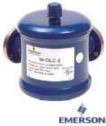
El W-OLC controla el nivel de aceite en el cárter de los compresores semi-herméticos con una válvula accionada por un flotador y, mantiene el nivel de aceite en el nivel recomendado por el fabricante del compresor.
