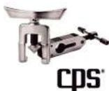
El mecanismo de sujeción universal del tubo se ajusta para sujetar tubos de 3/16 a 5/8 IN (4,75 a 16 MM) de diámetro externo. El cono de abocinado facetado exclusivo bruñe automáticamente la cara abocinada durante el funcionamiento. Incluye: (FTX516) Conjunto de yugo para FT525 (Cantidad / paquete 1), (FTX517) Conjunto de sujeción de tubo para FT525 (Cantidad / Paquete 1) y (FTX518) Cono de abocinado para FT525 (Cantidad / Paquete 1).
