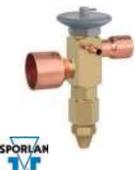
Cuerpo de latón, válvula de ajuste externo. La conexión de entrada tiene un filtro permanente de malla 12. Esta válvula incorpora construcción de puerto equilibrado, para aplicaciones de aire acondicionado y refrigeración.
