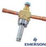
La 200RD es una válvula solenoide de dos vías, normalmente cerrada, operada por piloto. Es adecuada para todos los refrigerantes incluyendo R410A. La válvula 200RD es usada para líneas de líquido, descarga o succión.
