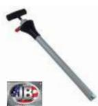
Diseñado para bombear aceite al sistema mientras la unidad está funcionando sin apagarse. Suavemente bombea aceite al compresor en la carrera descendente mientras el sistema está bajo presión. Adaptador de goma cónico universal diseñado para adaptarse a todos los contenedores de 1, 2-1/2 y 5 GAL sin adaptadores adicionales. Funciona contra 200 PSI de presión y es compatible con todos los tipos de aceites, incluidos los ésteres sintéticos, minerales y de poliolester.
