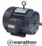
Motores que cumplen o excede eficiencia nema premium®. Modelos nema premium® cumplen con norma EISA2007. Carcaza y tapas de hierro en algunos modelos. Uso inversor 10:1 torque variable, 10:1 torque constante, factor de servicio 1.0. Factor de servicio 1.15. Clase aislamiento F. Caja de conexiones F1, reversible a F2 disponible en algunos modelos. Reconocido UL, certificado CSA, marcado CE, NOM. Etiquetado 50/60 Hz, 190/380 V a la potencia inferior inmediata.
