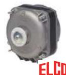
Potencia de salida de 5 a 34 Watts. 4 polos, rango de temperatura de 30 °C a más de 40 °C, una velocidad, rotación CCW. Expectativa de vida: más de 30,000 horas. Clasificación UL.
