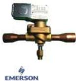
La 240RA es una válvula solenoide de dos vías, normalmente cerrada, de diafragma, operada por piloto para aplicación en líneas de líquido, gas de descarga y gas de succión en sistemas de refrigeración comercial y aire acondicionado.
