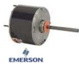
Motores para ventilador en unidades de condensación residencial y comercial en ubicaciones de temperatura extrema. Rodamiento de buje o chumacera. Totalmente cerrado. Armazón 48. No incluye capacitor de arranque; se recomienda usar el de 370 V.
