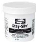
Un fundente multiuso a temperatura alta, para el uso en la soldadura fuerte de plata. Formulado para aplicaciones donde el trabajo está sujeto a calentamientos rápidos y localizados. Particularmente útil en aplicaciones donde se pueden formar grandes cantidades de óxidos refractarios, como con las aleaciones de acero inoxidable. Utilizar con acero inoxidable, carburos, partes pesadas, ciclos de calentamiento prolongados. La gama de temperaturas activas es 1050 °F / 566 °C - 1800 °F / 982 °C.
