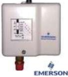
Los PS1 son presostatos de alta o baja presión para uso en sistemas de refrigeración, aire acondicionado y bombas de calor. Los PS1 también llamados controles de presión o interruptores de presión, han sido diseñados para abrir o cerrar un circuito eléctrico en función de la presión del sistema (conectar o desconectar), con aplicaciones específicas en cuanto a protección o control del sistema dependiendo lo que se requiera hacer.
