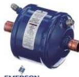
Filtro deshidratador para la línea de succión. Ideal para utilizarse después de una quemadura de compresor y/o en reparaciones mayores. Elimina humedad, ácido y partículas sólidas.
