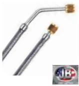
Mangueras de metal flexible de vacío profundo. A diferencia de las mangueras de carga, estas mangueras metálicas flexibles no permeará bajo el vacío. Estas líneas de metal tienen extremos de acoplador de junta tórica apretados con los dedos. 900 PSI de trabajo, revienta a 3500 PSI.
