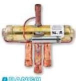
Las válvulas reversibles de 4 vías de Ranco® (Generación 4) están diseñadas para aplicaciones de bombas de calor, como las del tipo ventana, unitarias y sistemas divididos. Son el componente clave para proporcionar calefacción y refrigeración a través del sistema de bomba de calor invirtiendo la dirección en la que fluye el refrigerante.
