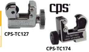
Mecanismos de alimentación de cojinetes de empuje de acero endurecido para un funcionamiento suave. Ruedas de corte de acero cromado mecanizadas con precisión. Mecanismo de alimentación de trinquete para un ajuste rápido al tamaño del tubo. Los rodillos tienen una ranura de corte abocinada para reducir la pérdida del tubo. Escariadores de acero endurecido plegables para desbarbar.
