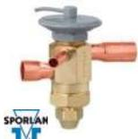
Cuerpo pequeño de latón, válvula de ajuste externo disponible para aplicaciones con refrigerante R22 y R410A de aire acondicionado y bombas de calor. Esta válvula incorpora una construcción de puerto equilibrado con válvula de retención para eliminar la necesidad de una válvula de retención en bypass en las aplicaciones de bombas de calor. se puede utilizar para reemplazar vet tipo OEM con o sin válvula de retención en estas aplicaciones. No incluye filtro a la entrada.
